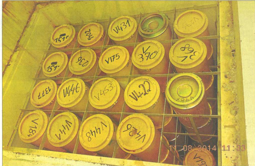
Stahlblechfässer mit radioaktivem Abfall lagern im Feststofflager des Kernkraftwerks Brunsbüttel.
