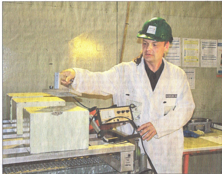
Ronny Fix-Faroldi misst die Strahlung in jedem einzelnen Steinblock. Anschließend erfolgt bei der Kontrollmessung eine weitere Überprüfung. Foto: Dießelkämper
