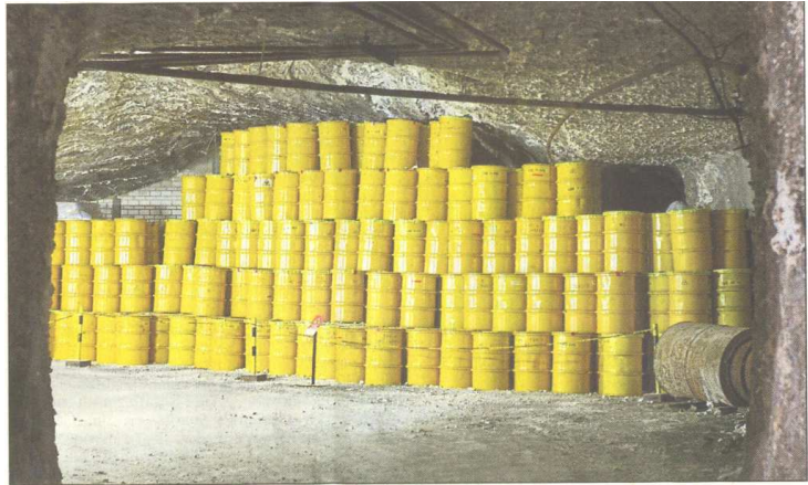
Gelbe Fässer für Atommüll stehen in rund 500 Metern Tiefe im Endlager für schwach und mittelradioaktiven Atommüll in Morsleben (Bördekreis): Noch in diesem Jahr soll die Suche nach einem Standort ganz von vorn beginnen. Foto: Wolf
